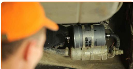
**15** Apriete la abrazadera de sujeción del tubo del filtro de combustible. Utilice un destornillador plano.
