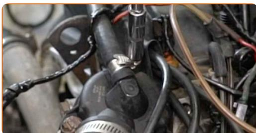
**10** Separe la manguera del vaso de expansión de la carcasa del termostato.
