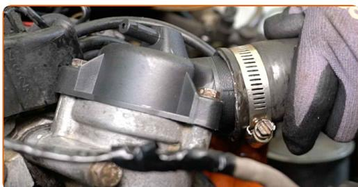
**22** Asegure la abrazadera de la manguera de refrigerante. Use un vaso de impacto del n.º 8. Utilice una llave de trinquete.
