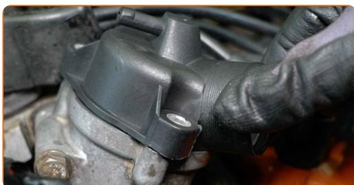
Sustitución: termostato refrigerante - MERCEDES-BENZ SL Coupé (C107).
