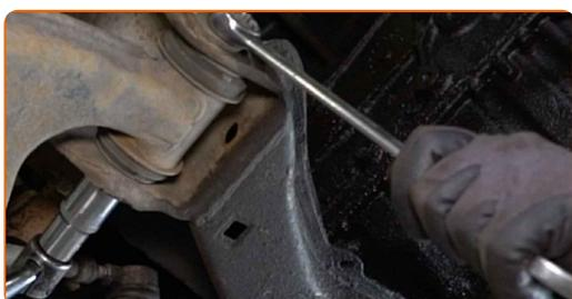
**17** Desenrosque la sujeción trasera del brazo de control. Usa una llave mixta del n.º 22. Use un vaso de impacto del n.º 22. Utilice una llave de trinquete.
