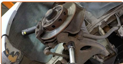
**7** Instale el compresor de resorte helicoidal en el resorte helicoidal.
