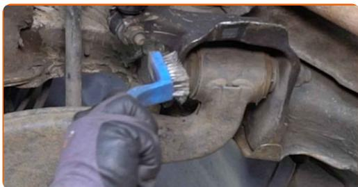
**15** Haga marcas en los pernos de ajuste de la inclinación.
