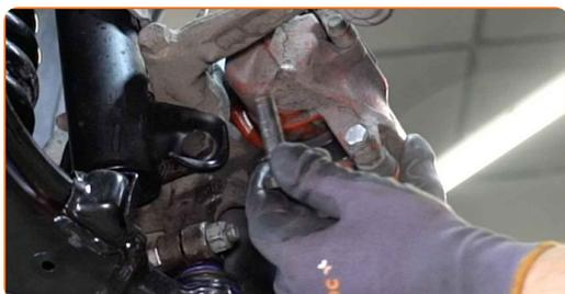
**12** Retire la pinza del freno junto con su soporte.
