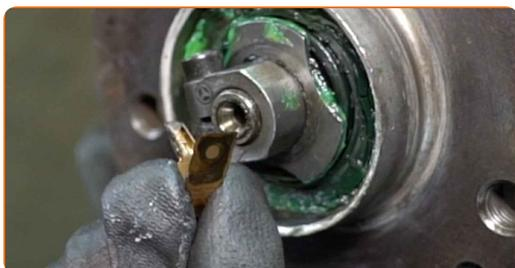
**19** Afloje el tornillo de la tuerca de sujeción del cubo de rueda. Use Vaso HEX No. H5. Utilice una llave de trinquete.
