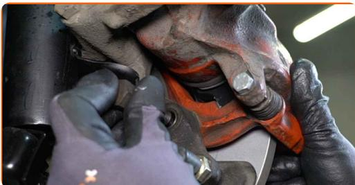
**44** Apriete las sujeciones del soporte de la pinza de freno. Use un vaso de impacto del n.º 19. Utilice una llave dinamométrica. Apriételo a un par de 115 Nm.
