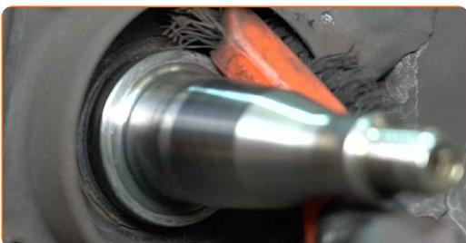
**24** Retire los elementos de los cojinetes del cubo de rueda. Utilice un juego de cubos y rodamientos.
