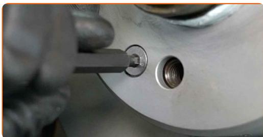
**36** Apriete las sujeciones del disco de freno. Use Vaso HEX No. H5. Utilice una llave dinamométrica. Apriételo a un par de 10 Nm.
