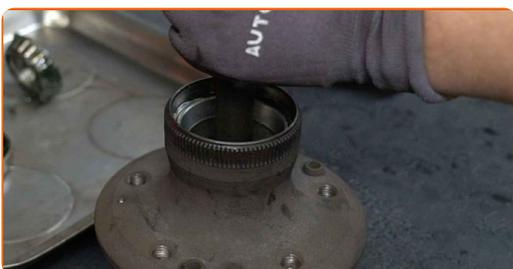
**25** Desmonte el anillo de rodamiento exterior. Utilice un juego de cubos y rodamientos. Utilice un extractor universal.
