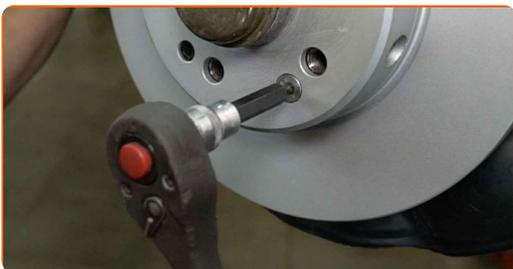
**15** Retire el perno de sujeción.
