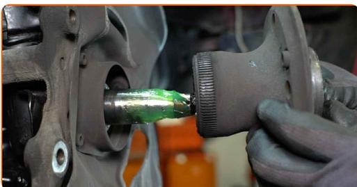
**22** Limpie el eje de la mangueta. Utilice un spray de limpieza multiuso.
