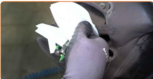
**23** Limpie el sensor ABS. Utilice un cepillo de limpieza de nylon. Utilice un spray de limpieza multiuso.
