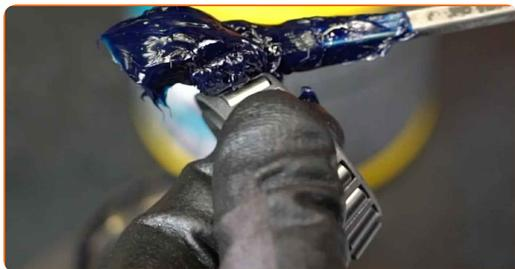
**29** Vuelva a instalar los elementos de los cojinetes en el cubo de rueda.
