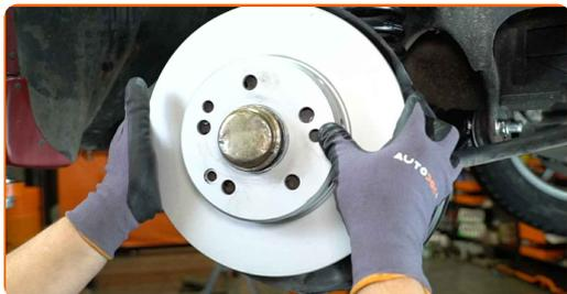
**35** Instale el perno de sujeción.
