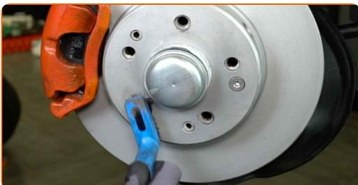
**46** Trate la superficie donde el disco del freno entra en contacto con la llanta de la rueda. Utilice grasa cerámica.
