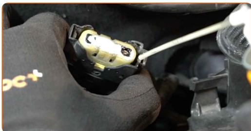
**17** Una el conector del sensor de flujo de masa de aire.
