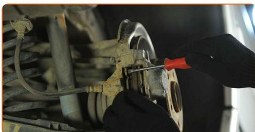
**9** Retire las pastillas de freno. Utilice un destornillador plano.
