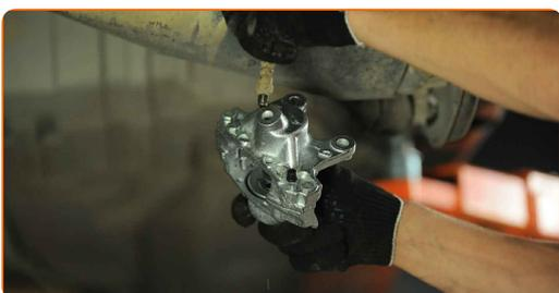
**19** Retire la abrazadera de la manguera del freno.
