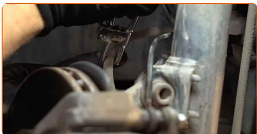
**11** Afloje la fijación del latiguillo de freno. Utilice una llave de tuerca abocinada #14.
