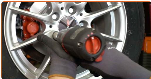
**22** Baje el automóvil y, manteniendo el orden cruzado, apriete los pernos de fijación de las ruedas. Utilice una llave de impacto para llanta # 17. Utilice una llave dinamométrica. Apriételo a un par de 110 Nm.
