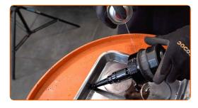
Instale nuevas juntas tóricas y un nuevo filtro de aceite en los asientos de montaje de la tapa del filtro.
