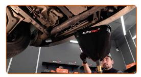
Destornille el tapón de desagüe. Usa una llave mixta del n.º 13.
