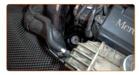
Atornille la tapa. Utilice el vaso 76-14F. Utilice una llave dinamométrica. Apriételo a un par de 25 Nm.
