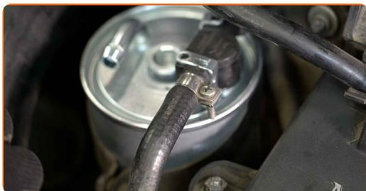
**13** Instale el sensor de presión de combustible.
