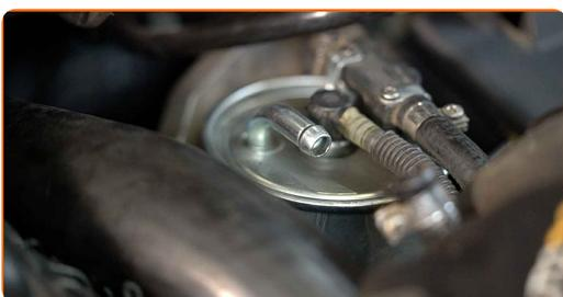
**6** Extraiga el sensor de presión de combustible. Use una palanca.
