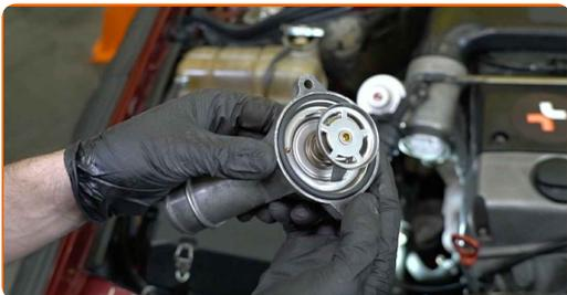
**25** Instale el termostato junto con la carcasa.
