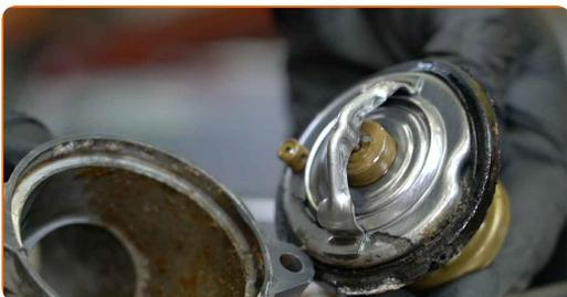
**23** Limpie el asiento de montaje del termostato. Use un cepillo de alambre. Utilice un spray de limpieza multiuso.
