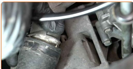
Sustitución: sensor de temperatura y termostato del refrigerante - MERCEDES-BENZ SPRINTER 3-t Autobús (903). AUTODOC recomienda:
