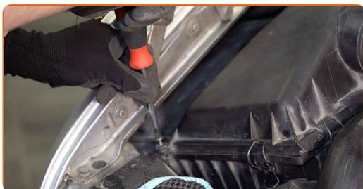
7 Suelte los clips de la cubierta del filtro de aire.
