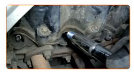
Atornille las buujías nuevas y apriételas. Use el vaso de bujía # 16. Utilice una llave dinamométrica. Apriételo a un par de 25 Nm.
