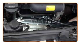
Destornille la atadura de la bobina del encendido. Use un vaso de impacto del n.º E11. Utilice una llave de trinquete.
