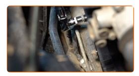
Enchufe el conector de la bobina de encendido.
