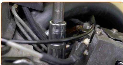
**35** Trate el conector del sensor de temperatura del líquido refrigerante. Utilice grasa dieléctrica.
