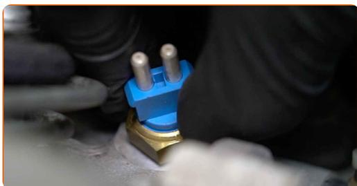
Sustitución: sensor de temperatura y termostato del refrigerante - MERCEDES-BENZ SPRINTER 3-t Furgón (903). Consejo de los expertos de AUTODOC:
