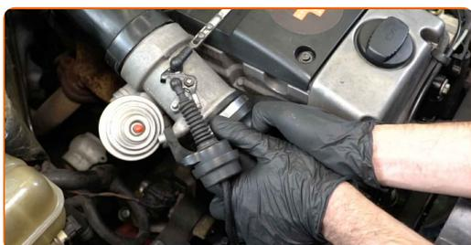
**39** Apriete las abrazaderas de la manguera del filtro de aire. Use un vaso de impacto del n.º 7. Utilice una llave de trinquete.
