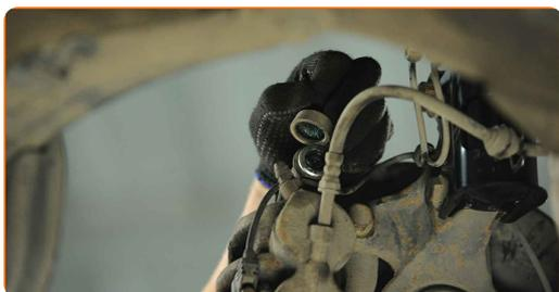
**8** Desconecte la clavija del sensor de desgaste de las pastillas de freno. Use alicates de punta redondeada.
