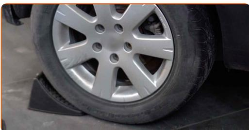
**3** Afloje los pernos de fijación de la rueda. Utilice una llave de impacto para llanta # 17.
