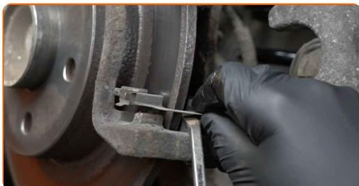
**17** Instale los muelles de retención de las pastillas de freno.
