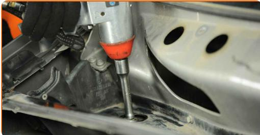
**52** Instale la tapa del soporte del amortiguador.
