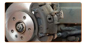
Conecte la clavija del sensor de desgaste de las pastillas de freno.
