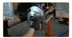
Apriete la fijación del disco de freno. Utilice un destornillador Phillips. Utilice una llave dinamométrica. Apriételo a un par de 9 Nm.
