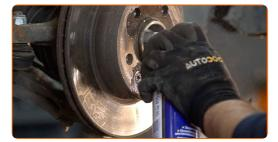
Destornille la fijación del disco de freno. Utilice un destornillador Phillips. Utilice un destornillador de impacto.
