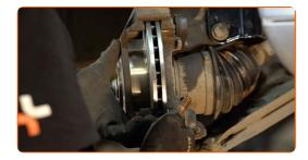
Apriete la fijación de la pinza del cáliper de freno. Use un vaso de impacto del n.º 21. Utilice una llave dinamométrica. Apriételo a un par de 162 Nm.
