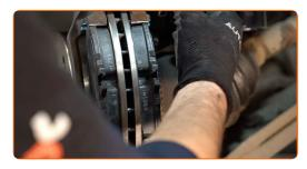
Establezcan el soporte de freno y lo fijen. Use un vaso de impacto del n.º 13. Utilice una llave dinamométrica. Apriételo a un par de 28 Nm.
