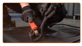
24 Instale la pinza del cáliper de freno.
