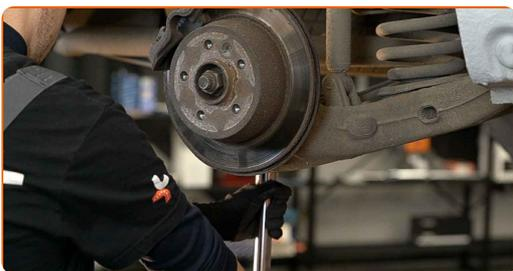
**7.1** Limpie las sujeciones del amortiguador.
