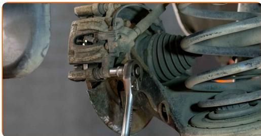
**9** Separe las pastillas de freno. Use una palanca.
