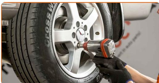
**25** Baje el automóvil y, manteniendo el orden cruzado, apriete los pernos de fijación de las ruedas. Utilice una llave de impacto para llanta # 17. Utilice una llave dinamométrica. Apriételo a un par de 130 Nm.
