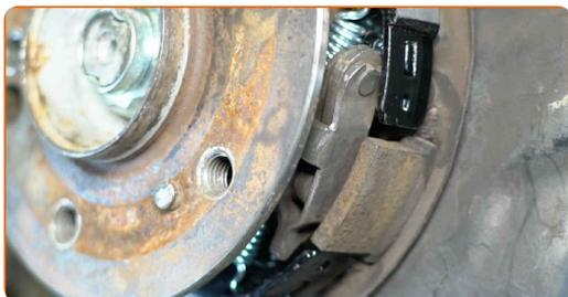
**45** Ajuste la tensión del cable del freno de mano. Use un vaso de impacto del n.º 13. Utilice una llave de trinquete.
