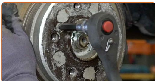
**19** Retire el perno de sujeción.
