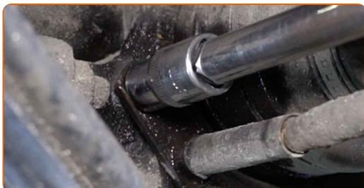
**27** Retire el perno de sujeción.
