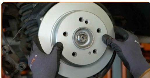
**49** Instale el perno de sujeción.
