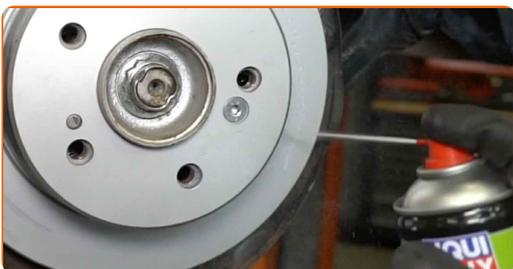
**59** Trate la superficie donde el disco del freno entra en contacto con la llanta de la rueda. Utilice grasa cerámica.
