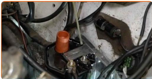
**17** Atornille los terminales de la bobina de encendido. Use un vaso de impacto del n.º 10. Utilice una llave de trinquete.
