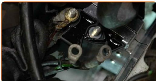
**16** Trate los terminales de la bobina de encendido. Utilice grasa dieléctrica.
