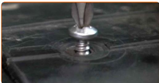
**22** Atornille las sujeciones del tubo de admisión. Utilice un destornillador Phillips. Use un vaso de impacto del n.º 10. Utilice una llave de trinquete.
