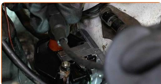
**19** Coloque la cubierta de la bobina de encendido.
