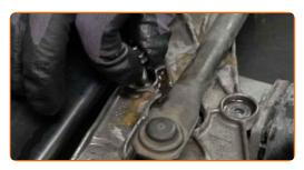
Separe el varillaje de limpiaparabrisas del eje del motor.
