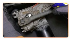
Desenrosque la sujeción que conecta el varillaje con el eje del motor del limpiaparabrisas. Use un vaso de impacto del n.º 13. Utilice una llave de trinquete.
