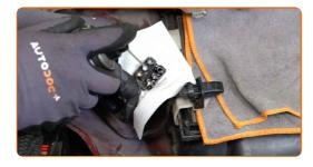
Limpie el asiento de montaje del mecanismo del limpiaparabrisas. Use un cepillo de alambre. Utilice un spray de limpieza multiuso.
