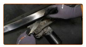
Limpie las sujeciones del motor del limpiaparabrisas. Use un cepillo de alambre. Use el aerosol WD-40.
