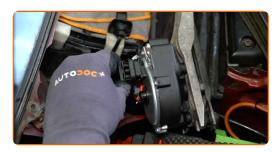
Apriete las sujeciones del mecanismo del limpiaparabrisas. Use un vaso de impacto del n.º 10. Utilice una llave dinamométrica. Apriételo a un par de 13 Nm.
