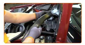
Desenrosque las sujeciones del drenaje. Utilice un destornillador Phillips.
