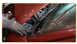
Instale el elemento central que sujeta la junta de la cubierta de la rejilla del limpiaparabrisas.
