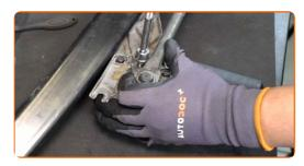
Limpie el conector del motor del limpiaparabrisas. Utilice grasa dieléctrica.
