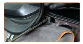
Desenchufe el conector del motor del limpiaparabrisas.
