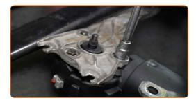
Instale el varillaje de limpiaparabrisas en el eje del motor. Utilice una regla.
