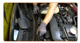
Retire el elemento central que sujeta la junta de la cubierta de la rejilla del limpiaparabrisas.
