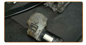
Limpie el asiento de montaje del motor del limpiaparabrisas. Use un cepillo de alambre. Utilice un spray de limpieza multiuso.
