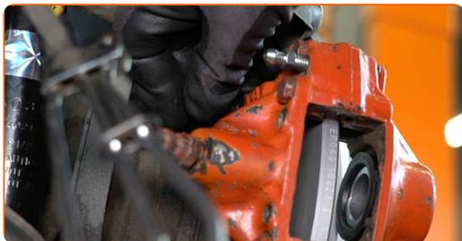
**44** Apriete las sujeciones de la pinza del freno. Use un vaso de impacto del n.º 17. Utilice una llave dinamométrica. Apriételo a un par de 65 Nm.
