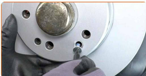
**27** Apriete las sujeciones del disco de freno. Use Vaso HEX No. H5. Utilice una llave dinamométrica. Apriételo a un par de 10 Nm.
