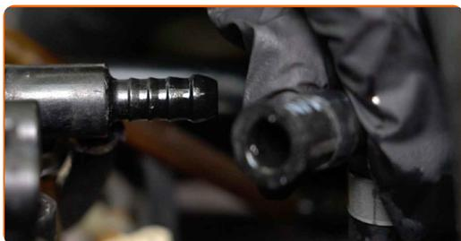
**13** Ceebe el sistema de combustible manualmente. Utilice una bomba de combustible de mano de bombilla.
