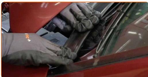
**16** Instale el elemento central que sujeta la junta de la cubierta de la rejilla del limpiaparabrisas.
