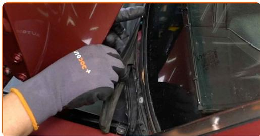
5 Desenrosque las sujeciones del drenaje. Utilice un destornillador Phillips.
