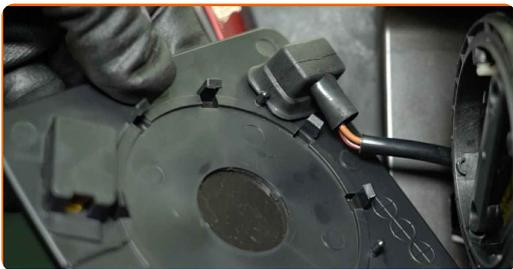
**5** Separe el conector de la calefacción del espejo.
