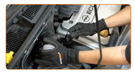
Afloje los tornillos de sujeción de la cubierta del filtro de aire. Utilice un destornillador Phillips.
