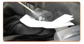
Enchufe el conector del sensor de flujo de aire.
