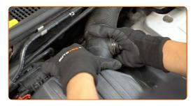
Fije la abrazadera en el manguito de admisión de aire. Use un vaso de impacto del n.º 7. Utilice una llave de trinquete.
