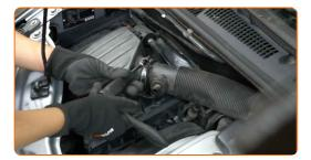
17 Trate el conector del sensor de flujo de masa de aire. Utilice spray para electrónica.
