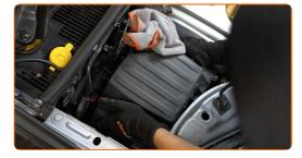
Atornille los tornillos de sujeción de la cubierta del filtro de aire. Utilice un destornillador Phillips.
