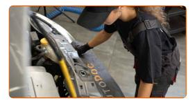
Suelte la abrazadera del manguito de admisión de aire. Use un vaso de impacto del n.º 7. Utilice una llave de trinquete.
