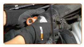
6 Desenchufe el conector del sensor de flujo de aire.
