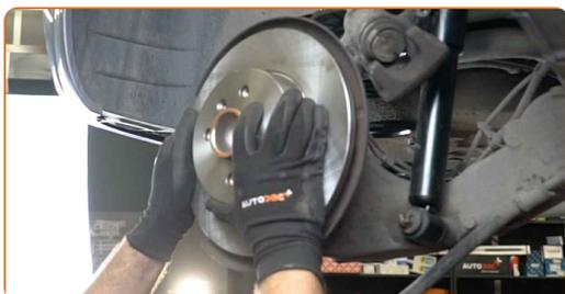
**40** Apriete la fijación del disco de freno. Utilice Torx T30. Utilice una llave dinamométrica. Apriételo a un par de 8 Nm.
