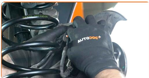
**37** Trate los sujetadores del cojinete del cubo de la rueda. Use grasa de cobre.
