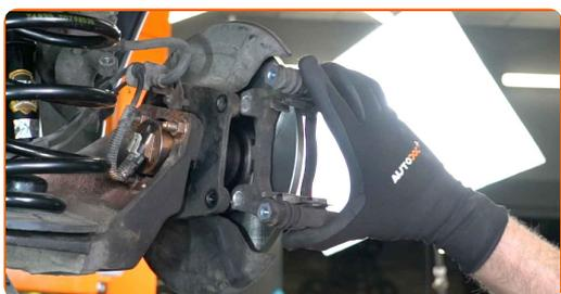
**43** Apriete la fijación de la pinza del cáliper de freno. Use un vaso de impacto del n.º E20. Utilice una llave dinamométrica. Apriételo a un par de 100 Nm.
