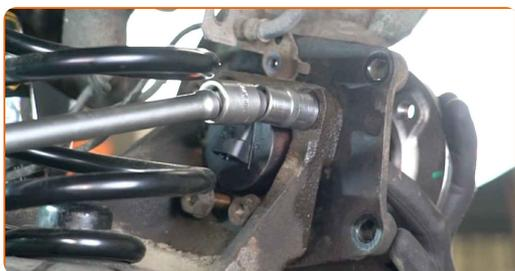
**31** Apriete las tuercas del cojinete del cubo. Use un vaso de impacto del n.º 16. Utilice una llave dinamométrica. Apriételo a un par de 50 Nm.+45°
