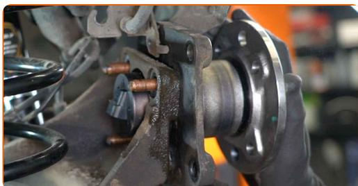
**30** Atornille las tuercas de los rodamientos del cubo. Use un vaso de impacto del n.º 16. Utilice una llave de trinquete.
