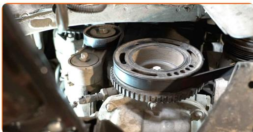
**10** Vuelva a colocar la polea tensora en su posición inicial. Usa una llave mixta del n.º 15.
