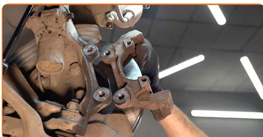
**25** Apriete la fijación de la pinza del cáliper de freno. Use un vaso de impacto del n.º 17. Utilice una llave dinamométrica. Apriételo a un par de 115 Nm.
