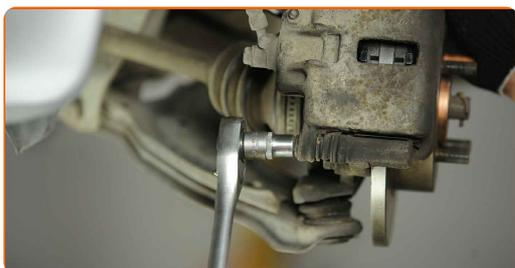
**31** Trate la superficie donde el disco del freno entra en contacto con la llanta de la rueda. Use grasa de cobre.
