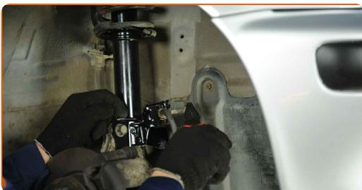
**7** Limpie las sujeciones que conectan el puntal amortiguador a la mangueta de dirección. Use un cepillo de alambre. Use el aerosol WD-40.
