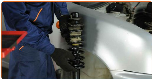
**34** Fije las sujeciones superiores del puntal amortiguador (3 piezas).
