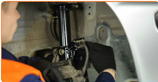
**45** Trate las sujeciones del amortiguador. Use grasa de cobre.
