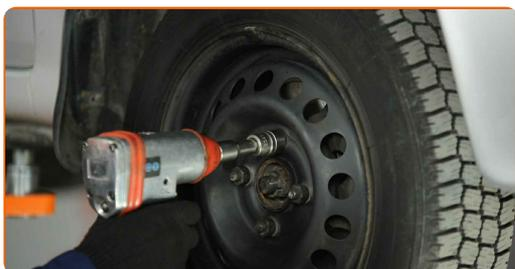
**50** Baje el automóvil y, manteniendo el orden cruzado, apriete los pernos de fijación de las ruedas. Utilice una llave de impacto para llanta # 19. Utilice una llave dinamométrica. Apriételo a un par de 110 Nm.
