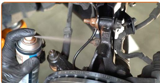
**46** Trate la superficie donde el disco del freno entra en contacto con la llanta de la rueda. Use grasa de cobre.
