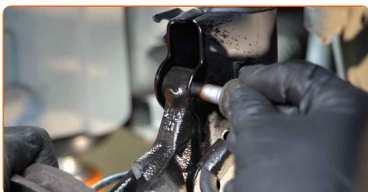
**42** Apriete las sujeciones inferiores que conectan el amortiguador con la mangueta de dirección. Usa una llave mixta del n.º 17. Use un vaso de impacto del n.º 17. Utilice una llave dinamométrica. Apriételo a un par de 115 Nm.
