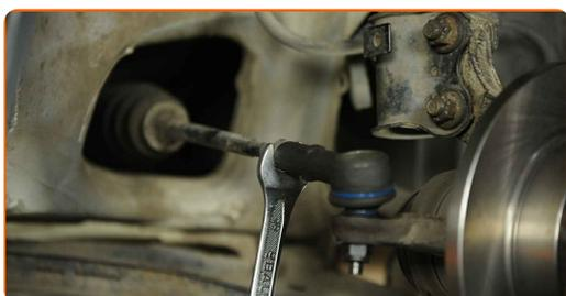
**18** Trate la sujeción que conecta el extremo de la barra de acoplamiento a la mangueta de dirección. Use grasa de cobre.
