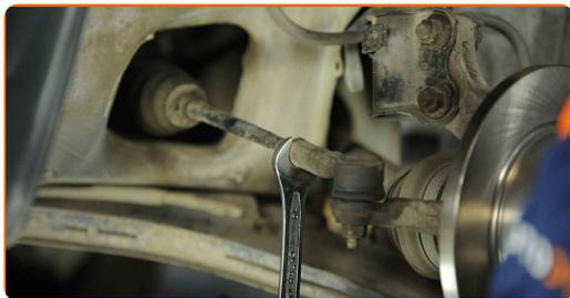
**9** Limpie las sujeciones que conectan el extremo de la barra de acoplamiento con la mangueta de dirección. Use un cepillo de alambre. Use el aerosol WD-40.
