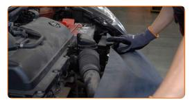
Desconecte la sujeción de la manguera de admisión de aire. Utilice una herramienta de extracción de clips.
