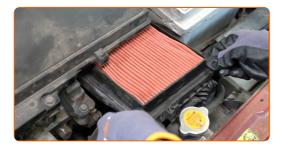
Retire el elemento filtrante de la carcasa del filtro.
