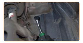
Afloje la sujeción de la polea tensora. Usa una llave mixta del n.º 14.
