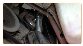
Gire el cigüeñal varias veces para asegurarse de que las nuevas correas poli V funcionan correctamente. Use un vaso de impacto del n.º 27. Utilice una llave de trinquete.
