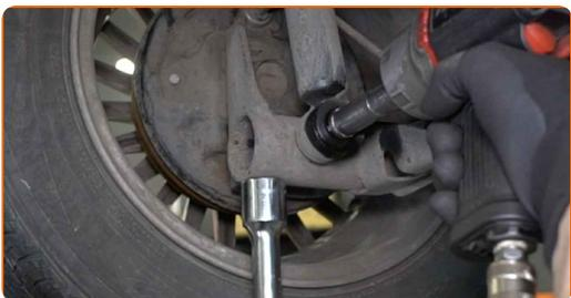
**9** Retire el perno de sujeción.
