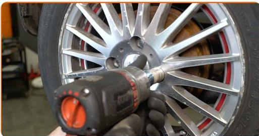
**35** Baje el automóvil y, manteniendo el orden cruzado, apriete los pernos de fijación de las ruedas. Utilice una llave de impacto para llanta # 17. Utilice una llave dinamométrica. Apriételo a un par de 110 Nm.
