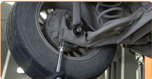
**8** Desenrosque las sujeciones inferiores del amortiguador. Use un vaso de impacto del n.º 16. Utilice una llave de trinquete.
