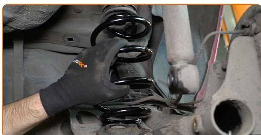
**18** Sostenga el eje de torsión de la suspensión trasera. Utilice un gato de transmisión hidráulica.
