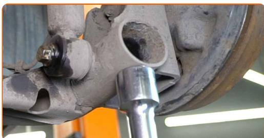
**12** Desenrosque las sujeciones inferiores del amortiguador. Use un vaso de impacto del n.º 16. Utilice una llave de trinquete.
