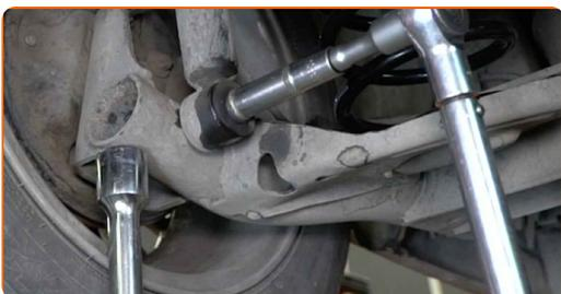
**22** Retire el apoyo situado debajo del eje rígido trasero.
