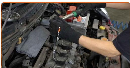
**31** Trate los conectores de las bobinas de encendido aplicando un spray limpiador para contactos eléctricos.
