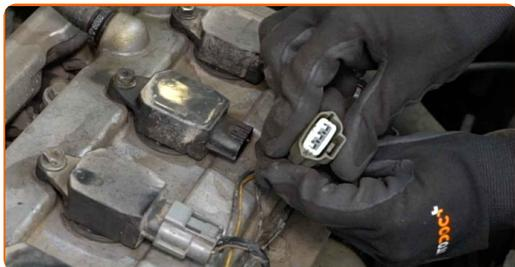
**19** Desatornille las sujeciones de las bobinas del encendido. Use un vaso de impacto del n.º 10. Utilice una llave de trinquete.
