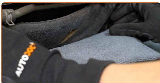
**15** Desenrosque las sujeciones de la cubierta inferior del motor. Use un vaso de impacto del n.º 10. Utilice una llave de trinquete.
