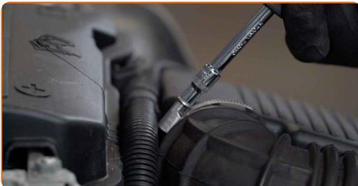
**4** Afloje los tornillos de sujeción de la cubierta del filtro de aire. Use un vaso de impacto del n.º 8. Utilice una llave de trinquete.
