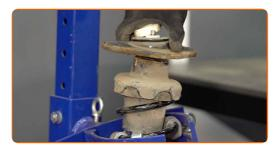
Apriete la tuerca de la varilla de la pata amortiguadora. Use Vaso HEX No. H6. Usa una llave mixta del n.º 19. Utilice una llave dinamométrica. Apriételo a un par de 30 Nm.
