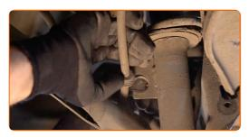
Destornille la fijación superior de la pata amortiguadora. Use un vaso de impacto del n.º 13. Utilice una llave de trinquete.
