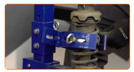
Destornille la tuerca de la varilla de la pata amortiguadora. Use Vaso HEX No. H6. Usa una llave mixta del n.º 19. Utilice una llave de trinquete.
