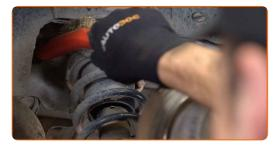
Destornille la fijación inferior de la pata amortiguadora. Use un vaso de impacto del n.º 21. Utilice una llave de trinquete. Utilice una llave giramachos.
