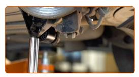
Apriete la fijación inferior de la pata amortiguadora. Use un vaso de impacto del n.º 21. Utilice una llave dinamométrica. Apriételo a un par de 140 Nm.
