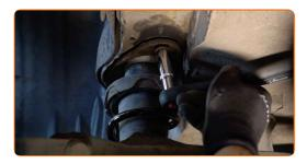
Instale la sujeción inferior del amortiguador.
