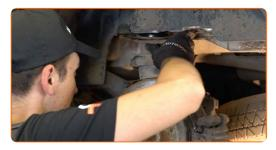
Apriete la fijación superior de la pata amortiguadora. Use un vaso de impacto del n.º 13. Utilice una llave dinamométrica. Apriételo a un par de 56 Nm.
