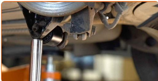
**23** Apriete la fijación inferior de la pata amortiguadora. Use un vaso de impacto del n.º 21. Utilice una llave dinamométrica. Apriételo a un par de 140 Nm.
