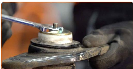
**Sustitución: copelas del amortiguador - MINI Hatchback (R56). Consejo:**
