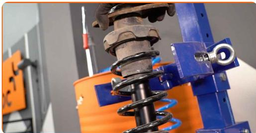
**19** Instale la pata amortiguadora en el arco de la rueda.
