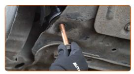
Instale el tornillo de sujeción delantero del brazo.
