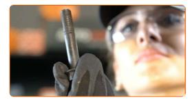
Desatornille la sujeción trasera que conecta el brazo de control al subchasis. Usa una llave mixta del n.º 21. Use un vaso de impacto del n.º 21. Utilice una llave de trinquete.
