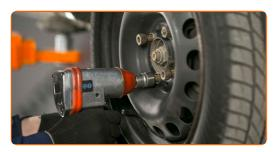
Baje el automóvil y, manteniendo el orden cruzado, apriete los pernos de fijación de las ruedas. Utilice una llave de impacto para llanta # 19. Utilice una llave dinamométrica. Apriételo a un par de 118 Nm.
