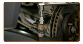
Trate todas las articulaciones del brazo. Trate todas las juntas de la bieleta o enlace estabilizador. Trate la sujeción que conecta el extremo de la barra de acoplamiento a la mangueta de dirección. Use grasa de cobre.
