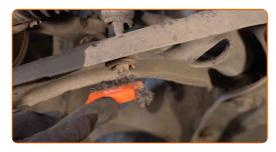
Destornille la fijación de la barra del estabilizador. Usa una llave mixta del n.º 13. Use un vaso de impacto del n.º 13. Utilice una llave de trinquete.
