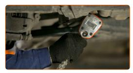
Atornille la fijación trasera de la palanca. Usa una llave mixta del n.º 21. Use un vaso de impacto del n.º 21. Utilice una llave de trinquete.
