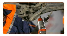
11 Retire el perno de sujeción.
