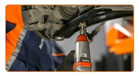
Conecte la punta de la barra de dirección al muñón de dirección.
