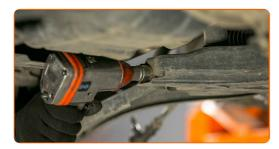
Retire la sujeción delantera del brazo de control.
