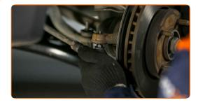
Apriete la tuerca de fijación que conecta el extremo de la barra de acoplamiento a la mangueta de dirección. Use un vaso de impacto del n.º 19. Utilice una llave dinamométrica. Apriételo a un par de 31 Nm.
