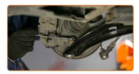
Apriete la sujeción delantera que conecta el brazo de control al subchasis. Usa una llave mixta del n.º 21. Use un vaso de impacto del n.º 21. Utilice una llave dinamométrica. Apriételo a un par de 145 Nm.
