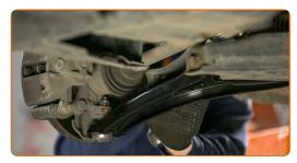
35 Instale el perno de sujeción.
