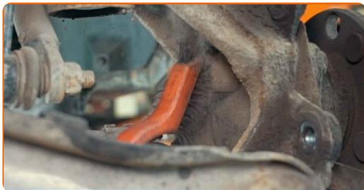
**19** Suelte el conector del sensor ABS.
