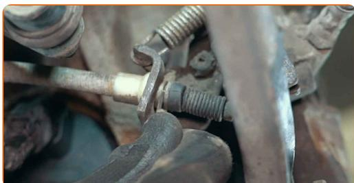
**40** Trate la superficie donde el disco del freno entra en contacto con la llanta de la rueda. Use grasa de cobre.
