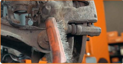
**9** Destornille la fijación del cáliper de freno. Usa una llave mixta del n.º 13.
