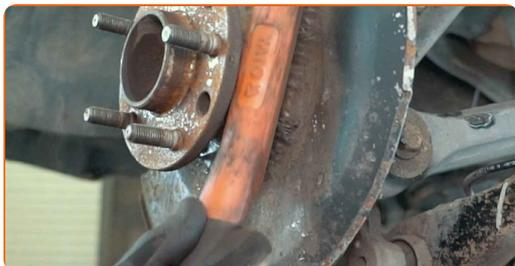
**21** Desenrosque los pernos del cubo de rueda. Utilice Torx T50. Utilice una llave giramachos.
