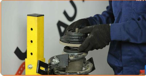
**54** Apriete la tuerca de la varilla de la pata amortiguadora. Use un vaso de impacto del n.º 21. Use Vaso HEX No. H7. Utilice una llave dinamométrica. Apriételo a un par de 80 Nm.
