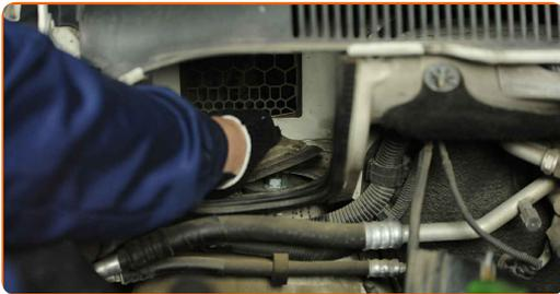
39 Limpie la sujeción superior del soporte del puntal de suspensión. Use un cepillo de alambre. Use el aerosol WD-40.
