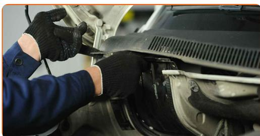
**64** Apriete los pernos de montaje de la cubierta protectora. Utilice Torx T30. Utilice una llave de trinquete.
