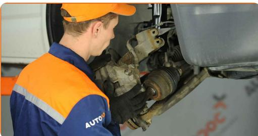
76 Desconecte el soporte esférico del muñón de dirección.
