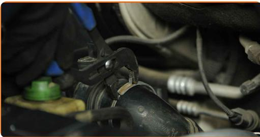
**32** Desconecte el tubo de entrada de aire de la carcasa del filtro de aire.
