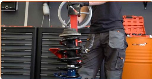
**56** Retire el puntal amortiguador que está montado.
