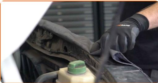
29 Desenchufe el conector del sensor de flujo de aire. Utilice un destornillador plano.
