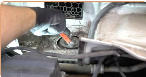
40 Desenrosque las sujeciones superiores del soporte del puntal de suspensión. Usa una llave mixta del n.º 21. Use Vaso HEX No. H7. Utilice una llave de trinquete.
