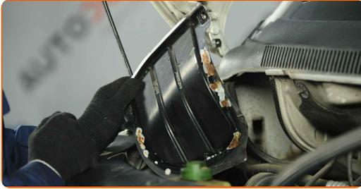
38 Quite la tapa del soporte del amortiguador. Use una palanca.
