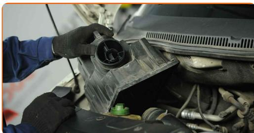
68 Conecte el tubo de entrada de aire a la carcasa del filtro de aire.
