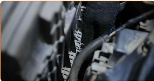
31 Suelte la abrazadera del manguito de admisión de aire. Utilice alicates para abrazaderas clic-R.
