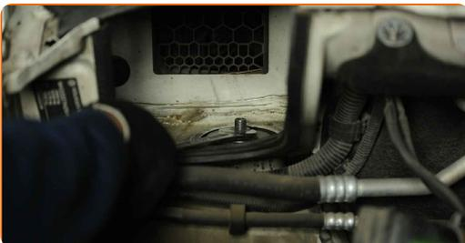
**62** Instale la tapa del soporte del amortiguador.
