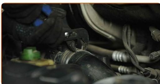
70 Presione los clips de la cubierta del filtro de aire en su lugar.
