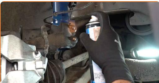
**93** Trate la superficie donde el disco del freno entra en contacto con la llanta de la rueda. Utilice grasa cerámica.
