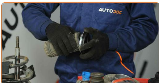
**53** Instale el soporte de montaje superior del puntal y el cojinete del soporte de montaje del puntal.
