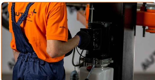
**71** Suelte la sujeción inferior que conecta el puntal amortiguador a la mangueta de dirección. Utilice un cincel de metal plano. Utilice un martillo.
