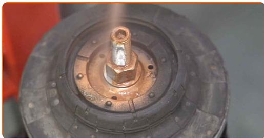
**54** Limpie los asientos de montaje del amortiguador. Use un cepillo de alambre. Use el aerosol WD-40.
