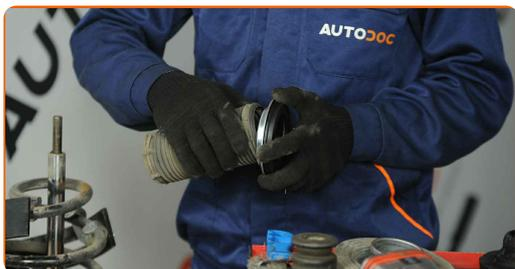
**49** Instale el soporte superior nuevo de la pata amortiguadora.
