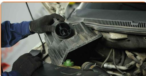
**64** Conecte el tubo de entrada de aire a la carcasa del filtro de aire.
