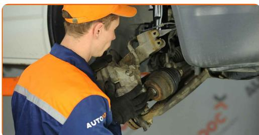
**72** Desconecte el soporte esférico del muñón de dirección.
