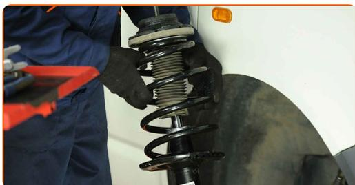
**56** Atornille las sujeciones superiores del soporte del puntal de suspensión.
