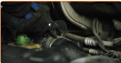
**66** Presione los clips de la cubierta del filtro de aire en su lugar.
