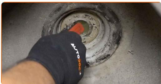
**55** Instale la pata amortiguadora en el arco de la rueda.
