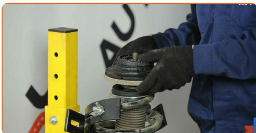
**50** Apriete la tuerca de la varilla de la pata amortiguadora. Use un vaso de impacto del n.º 21. Use Vaso HEX No. H7. Utilice una llave dinamo-métrica. Apriételo a un par de 80 Nm.
