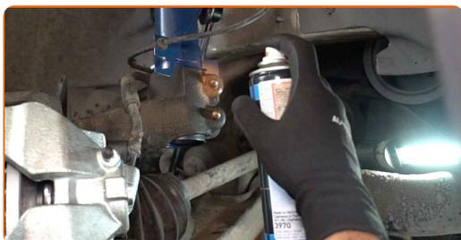
**89** Trate la superficie donde el disco del freno entra en contacto con la llanta de la rueda. Utilice grasa cerámica.
