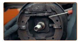
En primer lugar, retire las piezas que aseguran las zapatas de freno. Utilice un destornillador de horquilla o un juego de herramientas especial
