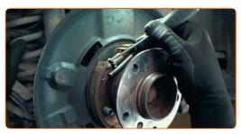
El acceso al engranaje del regulador se puede realizar a través del orificio del perno de la rueda o a través del orificio del cubo
