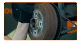
Compruebe el estado del regulador de freno, el mecanismo de regulación, los muelles de las zapatas y el tambor o el disco. Realice la sustitución donde sea necesario
