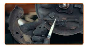
Desconecte los cables de la palanca de mando del freno de mano
