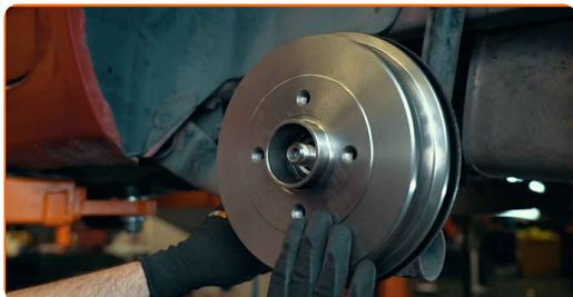
**31** Pise el pedal de freno y accione y suelte la palanca del freno de estacionamiento varias veces. Esto servirá para centrar las zapatas de freno respecto a la circunferencia del tambor
