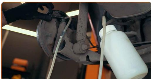
**24** Retire la abrazadera del latiguillo de freno flexible
