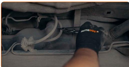
**25** El sistema es purgado mediante el bombeo del pedal de freno Repita el procedimiento hasta que no queden burbujas de aire en el líquido
