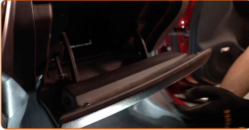
4 Destornille los tornillos de fijación de la guantera. Utilice un destornillador Phillips.
