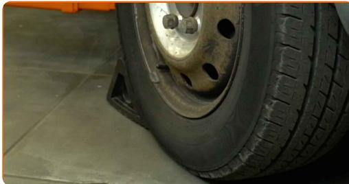
2 Afloje los elementos de sujeción de las ruedas. Utilice un vaso de impacto para ruedas de 24 mm. Utilice una llave giramachos con mango en T.
