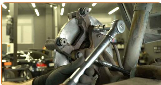
**35** Limpie el racor del latiguillo de freno que conecta el latiguillo con la pinza de freno. Utilice un cepillo de alambre. Utilice un spray limpiador multiusos.
