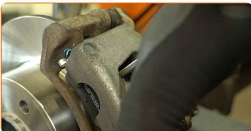
**11** Limpie los elementos de sujeción de la pinza de freno. Utilice un cepillo de alambre. Utilice el spray WD-40.
