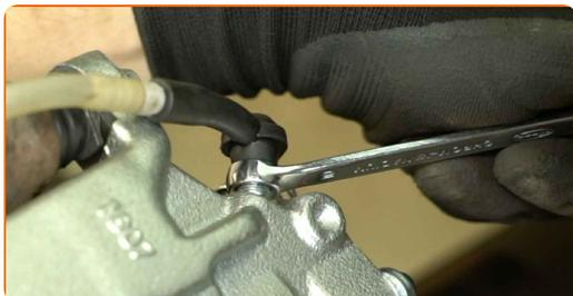
**49** Pise el pedal del freno varias veces para extraer el aire del sistema.
