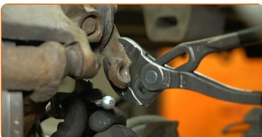
**10** Separe las pastillas de freno. Utilice una palanca de montaje.
