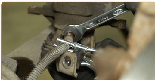
**21** Desenrosque el latiguillo de freno de la pinza de freno.
