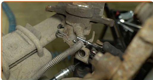
**19** Limpie el elemento de sujeción que conecta el latiguillo de freno a la pinza de freno. Utilice un cepillo de alambre. Utilice el spray WD-40.
