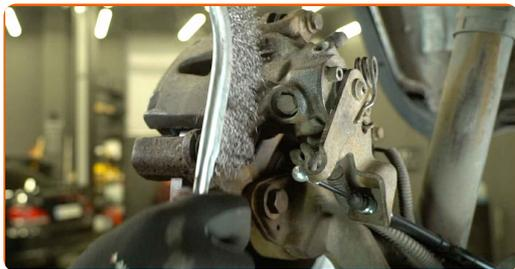
**12** Desenrosque los elementos de sujeción de la pinza de freno. Utilice una llave combinada de 19 mm. Utilice una llave de vaso de 13 mm. Utilice una llave de carraca.
