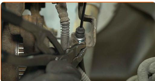
**9** Desconecte el cable del freno de mano de la palanca del freno de mano situada en la pinza. Utilice alicates ajustables.
