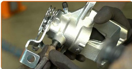
**37** Apriete firmemente la conexión del latiguillo de freno a la pinza de freno. Utilice una llave de vaso de tuerca abocinada de 14 mm. Utilice una llave dinamométrica. Par de apriete: 18 N·m.
