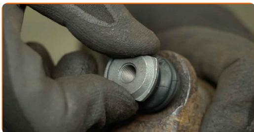
**32** Instale el soporte de la pinza de freno.
