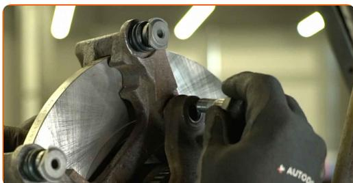
**34** Apriete los elementos de sujeción del soporte de la pinza de freno. Utilice una llave de vaso de 19 mm. Utilice una llave dinamométrica. Par de apriete: 110 N·m.
