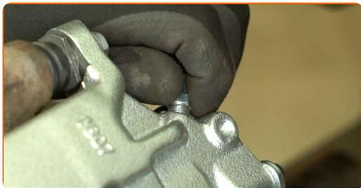
**47** Conecte el kit de purga de frenos al tornillo de purga de frenos.
