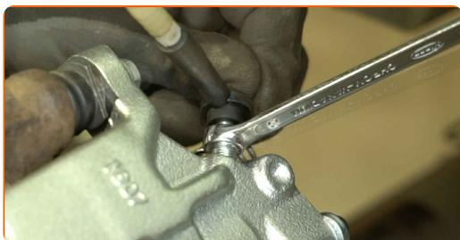
**48** Afloje el tornillo de purga de frenos. Utilice una llave combinada de 11 mm.
