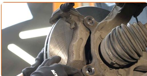
**20** Apriete la fijación de la pinza del cáliper de freno. Use un vaso de impacto del n.º 19. Utilice una llave dinamométrica. Apriételo a un par de 152 Nm.
