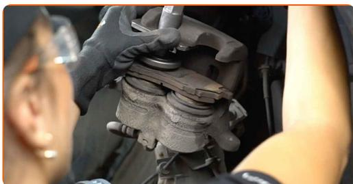
**24** Establezcan el soporte de freno y lo fijen. Usa una llave mixta del n.º 17. Use un vaso de impacto del n.º 14. Utilice una llave dinamométrica. Apriételo a un par de 34 Nm.
