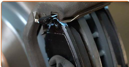
**22** Trate el pistón de la pinza de freno. Utilice un cepillo de limpieza de nylon. Use un limpiador de frenos.
